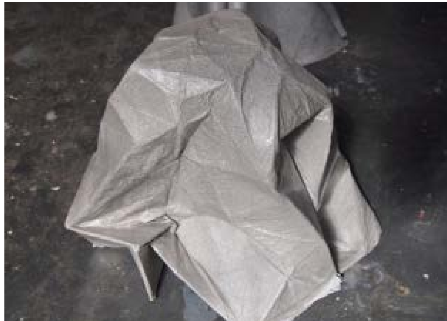
Probeversuch zur Faltung mit dreieckigen Pappstücken
