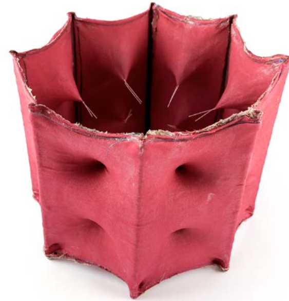
Vormodell - bestand 120kg Belastungsprobe
