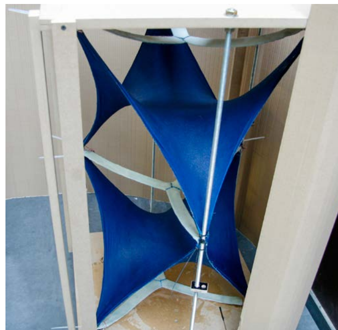
Pappmantel für die Benutzung als Trockenkammer
