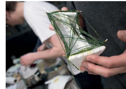
Erster Wickelversuch mit „Haken“
