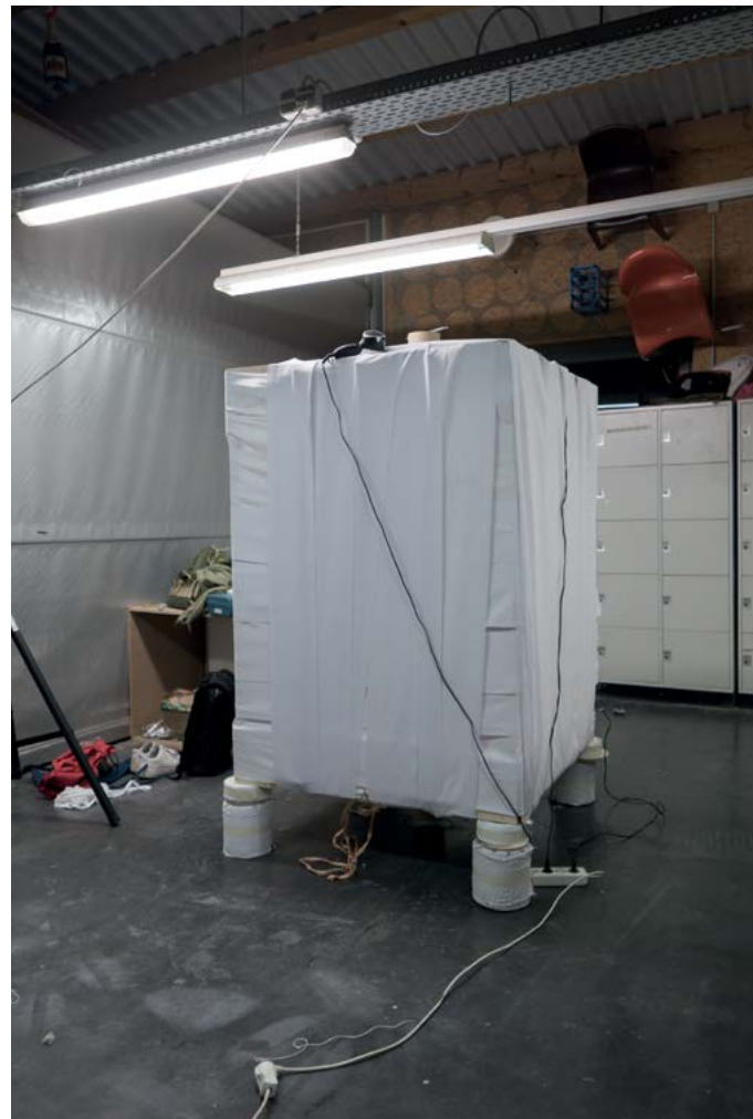
Der Rahmen eingewickelt mit Handtüchern - die Trockenkammer
