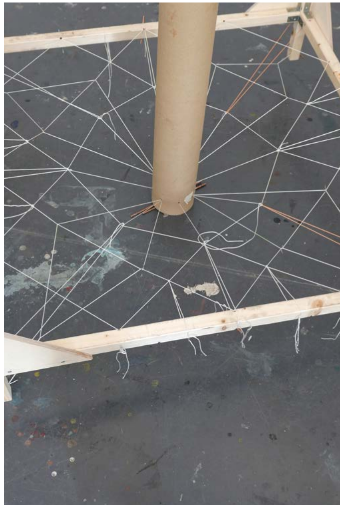
Schnüre um zu gewährleisten, dass die Spannung erhalten bleibt
